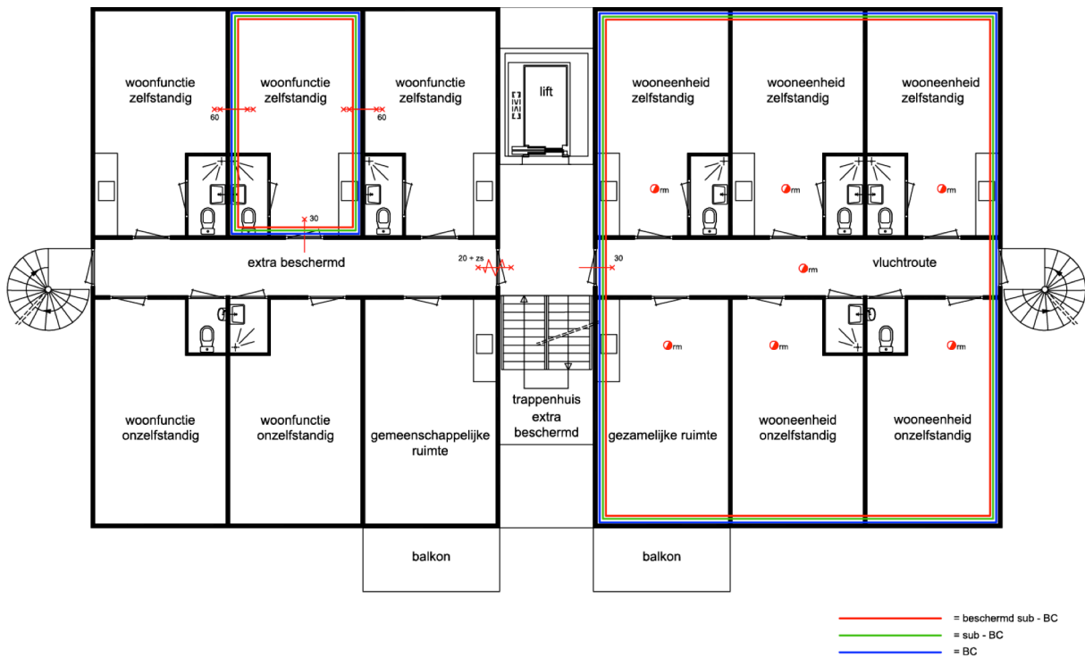
Figuur 9: Brandveiligheid, mogelijkheid 2 – alternatief rechtervleugel (kamerverhuur)
