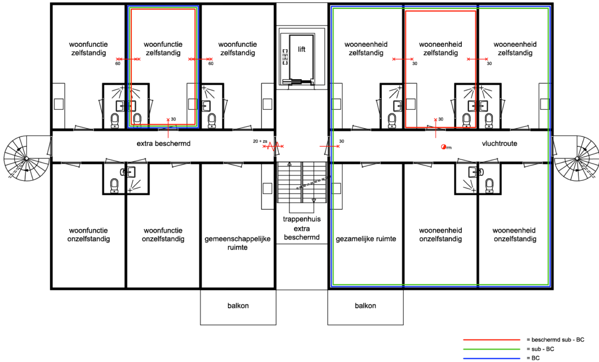
Figuur 8: Brandveiligheid, mogelijkheid 1 – plattegrond met basisvoorzieningen
